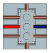
4. Установите монтажный блок и просверлите отверстия на стене, вставьте пластмассовы дюбел .
