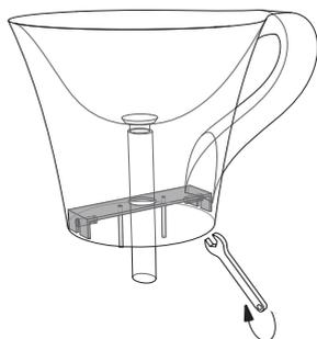
4. Serrare i bulloni per fissare la piastra posizionata in precedenza. Screw the bolts to fixing the plate located above.
