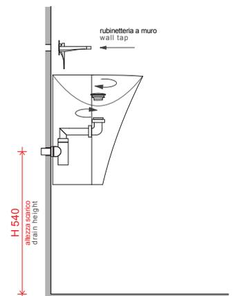
1. Forare la parete per posizionare le piastre di supporto alle quote indicate (H. 700 mm / L. 550 mm), utilizzando una punta da 10 mm; Ed inserire nel muro i tasselli in dotazione. Drill the wall to place the support plates (H. 700 mm / L. 550 mm), with a drill bit of 10 mm, and place the anchors in the wall.
